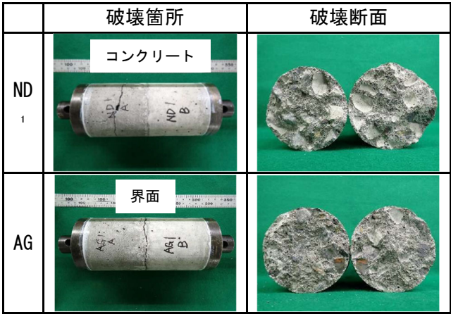
写真-2 打継処理を施した試験体(試験後)
